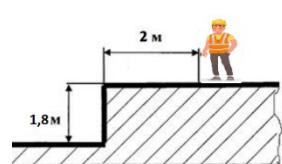
На границах зон с присутствием опасных производственных факторов находятся защитные и сигнальные ограждения, а также знаки безопасности.
