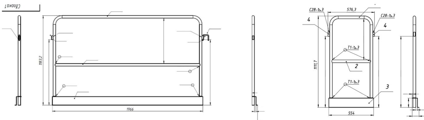
Рисунок 1. Схематичный вид защитного ограждения (с размерами).
