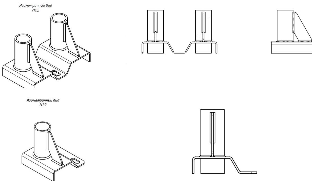
Рисунок 2. Схематичный вид основания (основание подбирается под ограждение).
